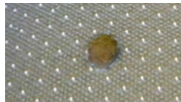
Quemadura > 3 mm, revestimiento perforado o roto, sin deterioro de la espuma
