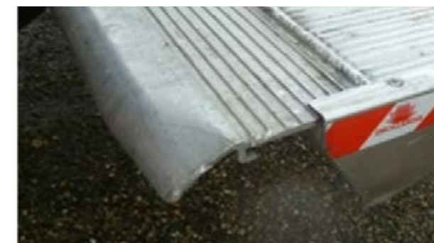
Compuerta de carga: Deformaciones de la plataforma que merece la pena de reparar
