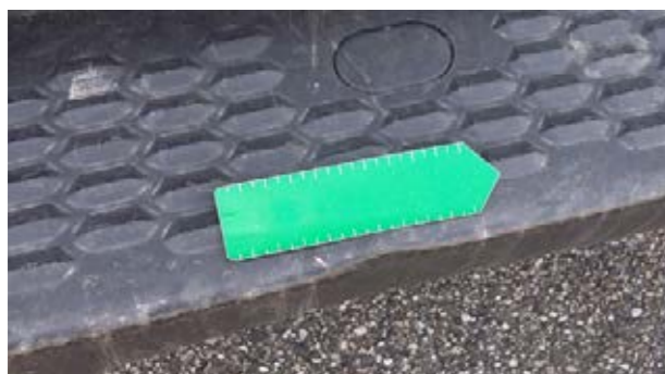
Estribos traseros: Ligera deformación
