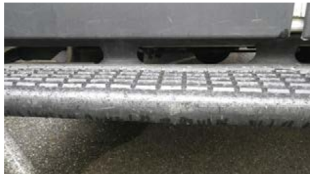
Pequeños arañazos en la pintura de los bordes de la zona de carga
