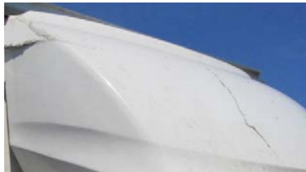
Cabover y deflector: Grieta grande, falta pieza o no merece la pena de repararse
