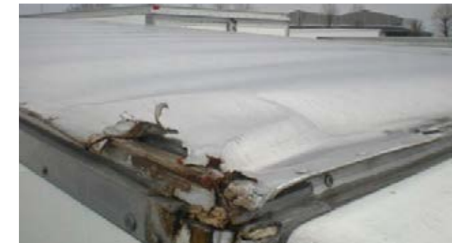
Zona del techo: Armazón dañado, la piel no merece la pena de repararse
