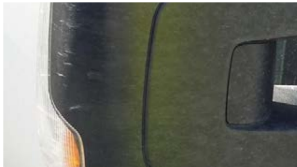
Arañazos imperceptibles al pasar la uña y con una superficie \leq 45 \text{ cm}^2 (como una tarjeta de crédito)
