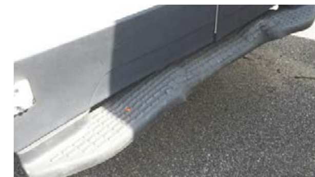
Estribos traseros: Deformaciones que no merece la pena de reparar
