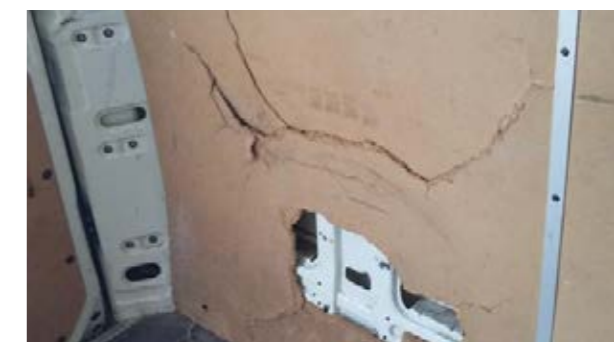
Protecciones internas de madera: Golpes, falta el panel o está roto (excluyendo los paneles superiores de la puerta)
