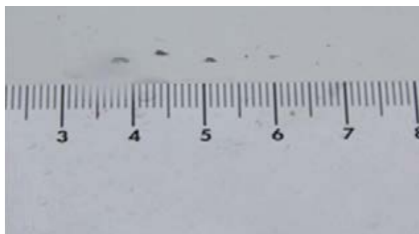
Astilla \leq 5 mm de diámetro y \leq 20 astillas
