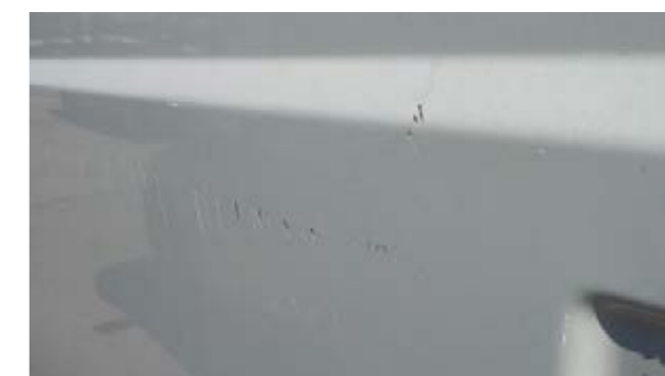
Arañazos > 20 mm Nota: En la puerta trasera batiente no se puede pintar medio panel
