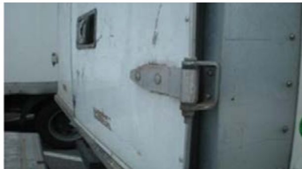
Puertas laterales y traseras: Puertas dobladas en los puntos de fijación de las bisagras, rotas, perforadas o que no merece la pena de reparar
