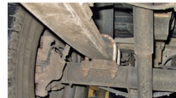
Fugas del engranaje de la dirección y de la bomba de dirección asistida
