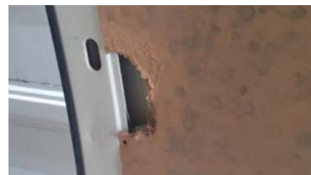
Protecciones internas de madera: Golpes, falta el panel o está roto (excluyendo los paneles superiores de la puerta)
