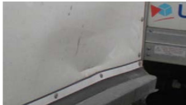
Puertas laterales y traseras: Importante deformación: Tiempo de reparación > 1 h no merece la pena de reparar, el cierre no es estanco
