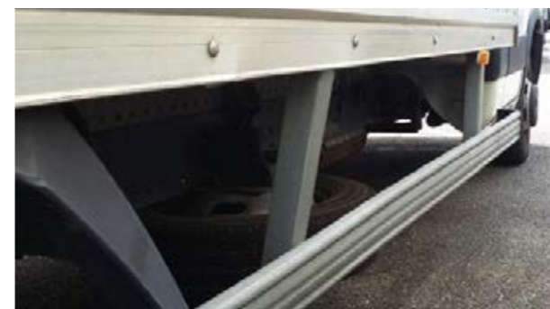
Portabicicletas: Deformación que merece la pena de reparar
