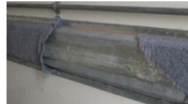
☰ Tapizados y varillas: Alfombra rota o desprendida
