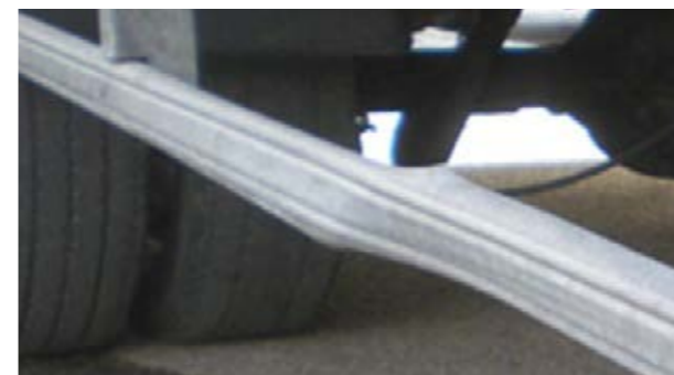
Portabicicletas: Deformación que no merece la pena de reparar
